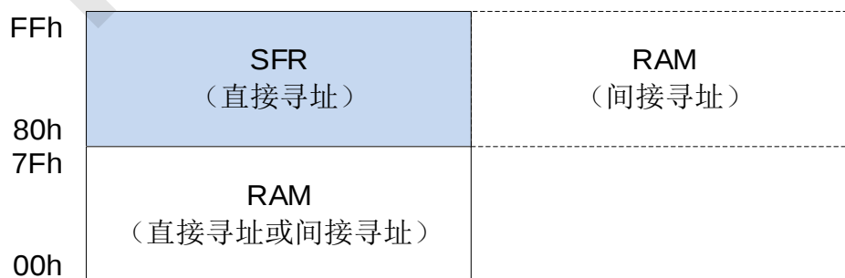
内部 256 bytes RAM 结构图
