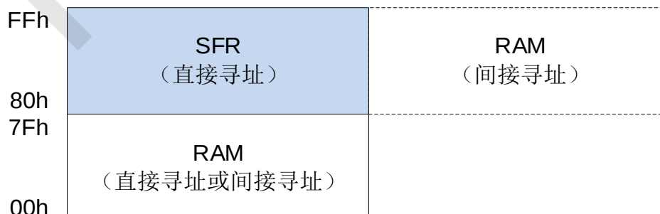
内部 256 bytes RAM 结构图
